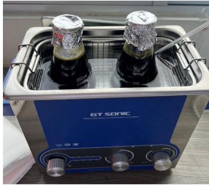
**Gambar 1.** Proses ekstraksi menggunakan UEA
