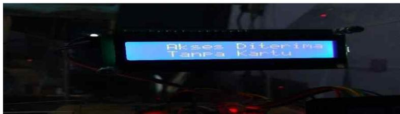
**Gambar 12** LCD saat Akses Diterima Tanpa Kartu. Jika pengguna kehilangan kartu, maka dapat dilakukan akses dengan cara memasukan password darurat yang berbeda dengan password OTP yang dimasukan ketika menggunakan kartu. Ketika kondisi tersebut LCD akan menampilkan “Akses Diterima tanpa kartu” , kunci akan terbuka dan SMS akan dikirimkan.
