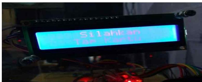
**Gambar 6** LCD saat Alat Siap Membaca Kartu. Pada saat alat Sistem Kunci Pintu RFID dan Password Berbasis Arduino Uno dengan One Time Password melalui SMS telah siap membaca kartu maka LCD akan menampilkan teks “Silahkan Tap Kartu”.
