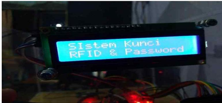
**Gambar 4** LCD Awal Alat saat Mencoba Mencari Sinyal dan Mengirimkan SMS. Pada saat alat Sistem Kunci Pintu RFID dan Password Berbasis Arduino Uno dengan One Time Password melalui SMS dinyalakan, maka LCD akan menampilkan tulisan “Sistem Kunci RFID & password ” sebagai penanda bahwa alat tersebut sedang mencari sinyal dan mencoba mengirimkan SMS.
