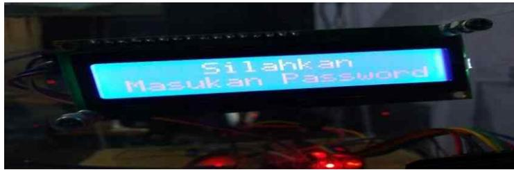
**Gambar 7** LCD saat Alat siap Membaca Password. Jika kartu yang dibaca cocok maka LCD akan menampilkan “silahkan Masukan Password” pengguna diharuskan memasukan password dengan benar sesuai dengan kode OTP yang dikirimkan ke nomor tujuan melalui SMS.
