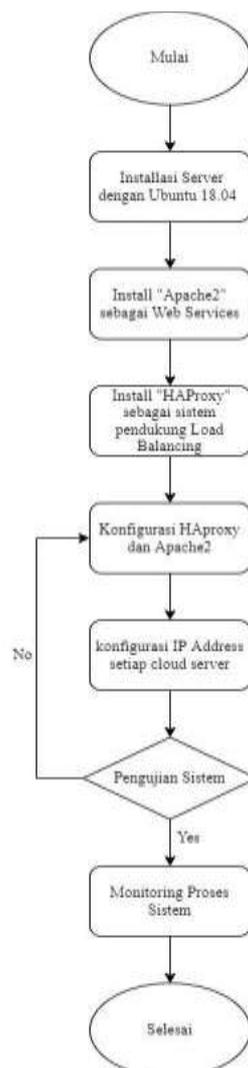
**Gambar. 5.** *Flowchart Tahapan Konfigurasi Pada Sistem Server Cloud Clustering Load Balancing Dengan HAProxy.*
