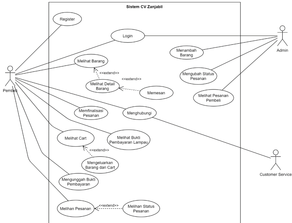
Gambar. 2. Use Case Diagram sistem penjualan jahe CV Zanjabil
