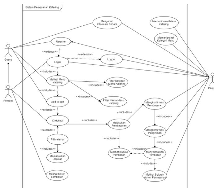
**Gambar. 2.** Use Case Diagram sistem pemesanan Hena Catering
