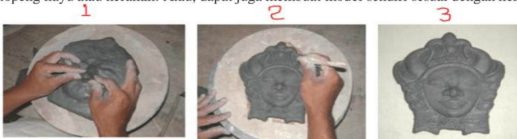
Secara umum, ada dua teknik cetak pada pembentukan karya keramik, yaitu teknik cetak tekan dan teknik cetak tuang.
